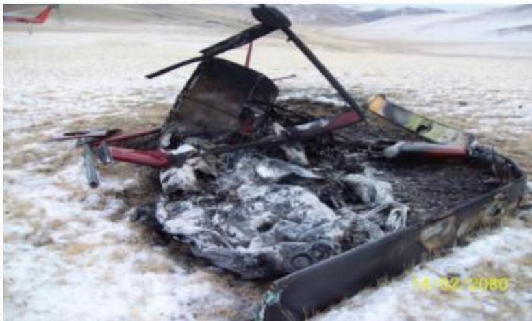
В связи с падением мощности двигателя КВС принял решение совершить вынужденную посадку. При посадке произошло опрокидывание вертолета на левый борт с последующим возникновением пожара. В результате пожара вертолет полностью сгорел.
