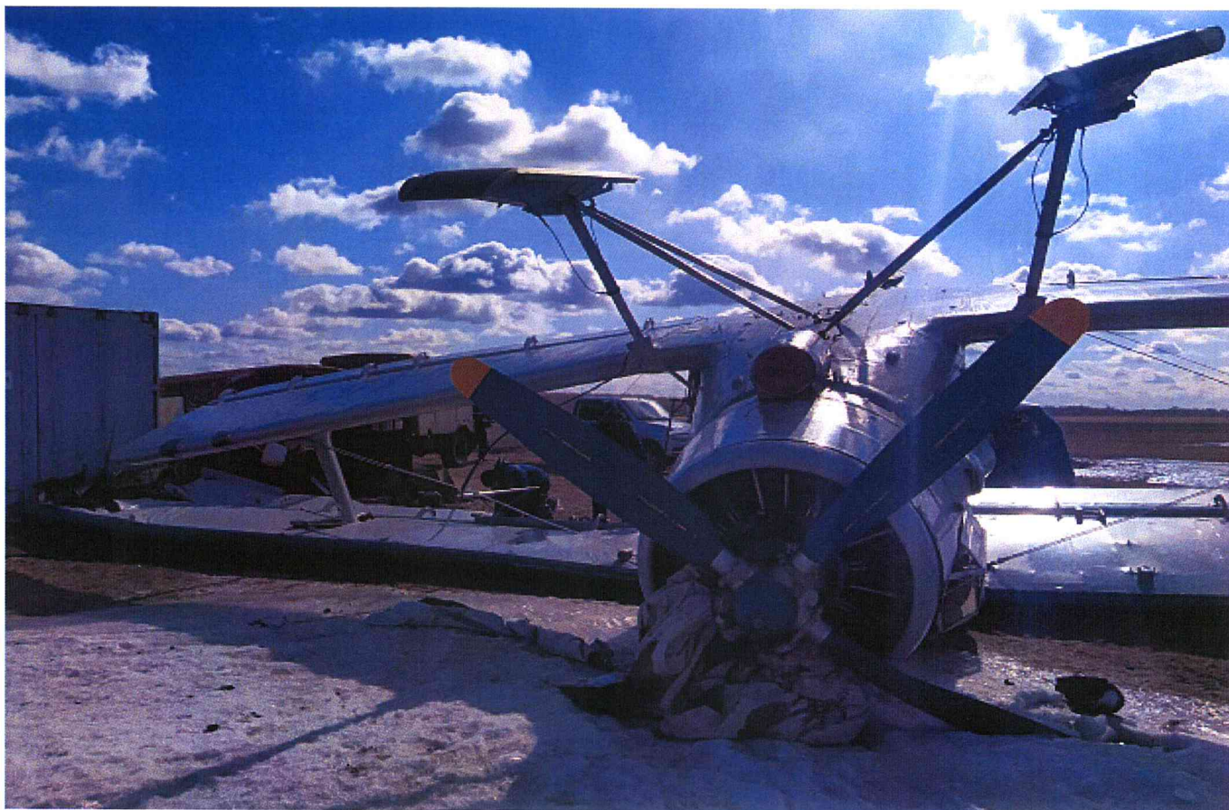
Повреждения правого крыльевого набора и воздушного винта
