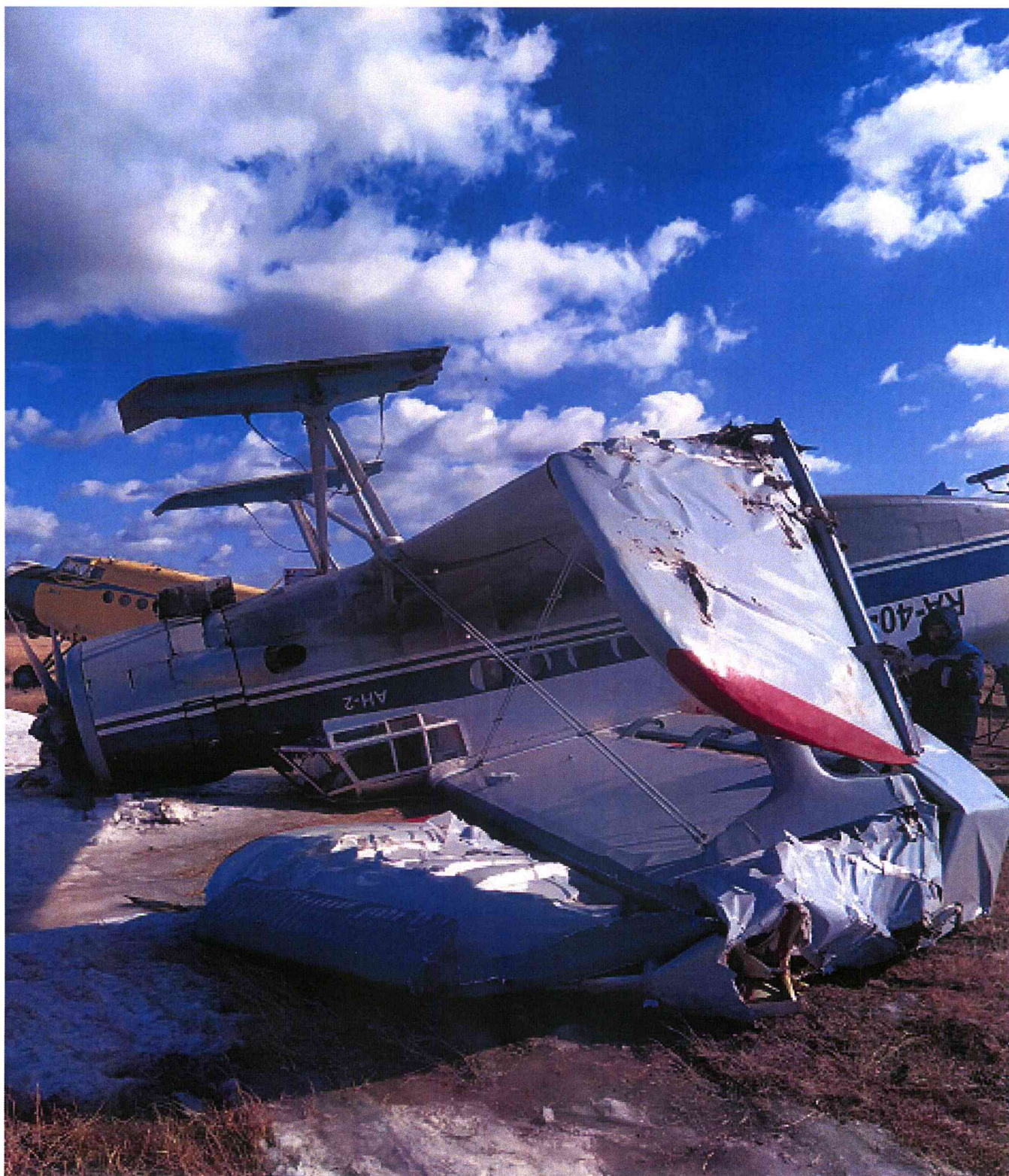
Повреждение правого крыльевого набора
