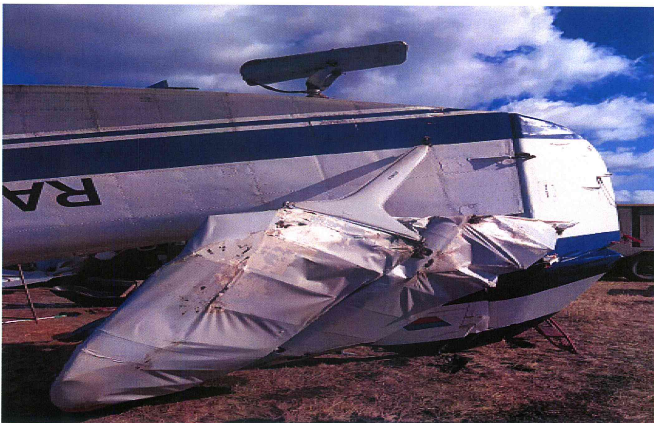
Повреждения хвостового оперения
